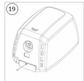
19 Colocar el tornillo de seguridad
