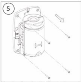
5 Desatornillar los tornillos de la pared (x4)
