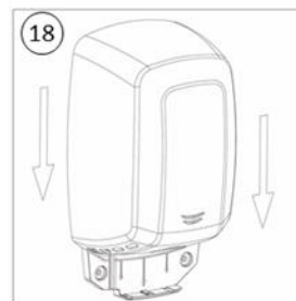
18 Montar el secador sobre la base con un movimiento vertical de arriba a abajo
