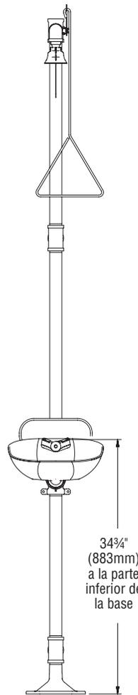
**✓** Todas las dimensiones asumen el enganche de rosca estándar. Las variaciones en la fabricación permiten +/- 3,1 mm (1/8") por junta roscada. Para encontrar la tolerancia de una dimensión, agregue el número de juntas roscadas entre una dimensión y multiplíquelo por 3,1 mm (1/8").
