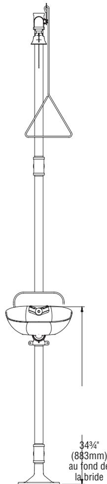
**✓** Toutes les dimensions supposent un engagement de filetage standard. Les variations de fabrication prévoient +/- 3,1 mm (1/8") par joint fileté. Pour trouver la tolérance d'une dimension, ajouter le nombre de joints filetés entre une dimension et le multiplier par 3,1 mm (1/8").
