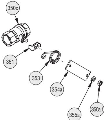
Paquet robinet laiton comprend les éléments 350a, 351, 353, 354a, 355a
