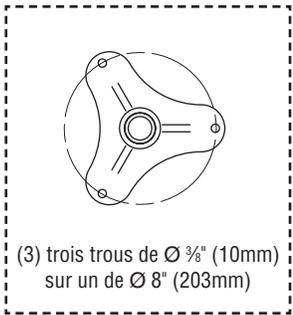
Pour une installation à pédale au pied en option, la base doit être positionnée de manière que le trou dans la base soit perpendiculaire à l'utilisateur.
